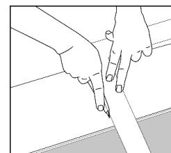
Соблюдайте компенсационный зазор 5-10мм до стен.
