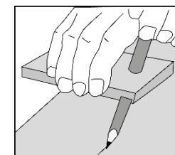
Перенесите форму стены на доску как показано на рисунке. Помните о 10 миллиметровом компенсационном зазоре до стены.
