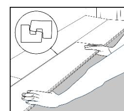
Расположите следующую планку таким образом, чтобы соединение по короткой стороне было без щели. В тоже время совместите замковую часть с шипом по длинной стороне с пазом предыдущего ряда и прижмите движением вниз. Используйте резиновый молоток или ручной валик для фиксации соединения.
